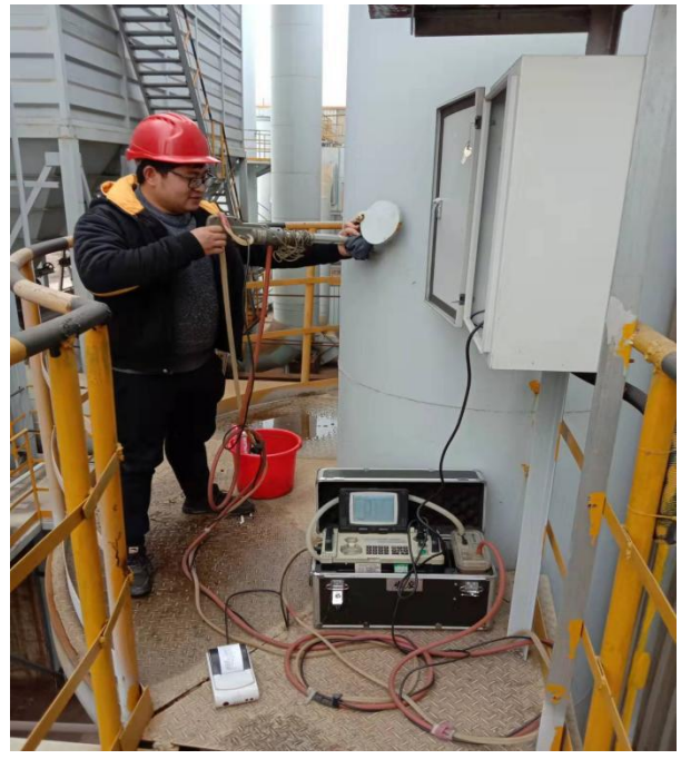
三磨废气处理设施出口监测
