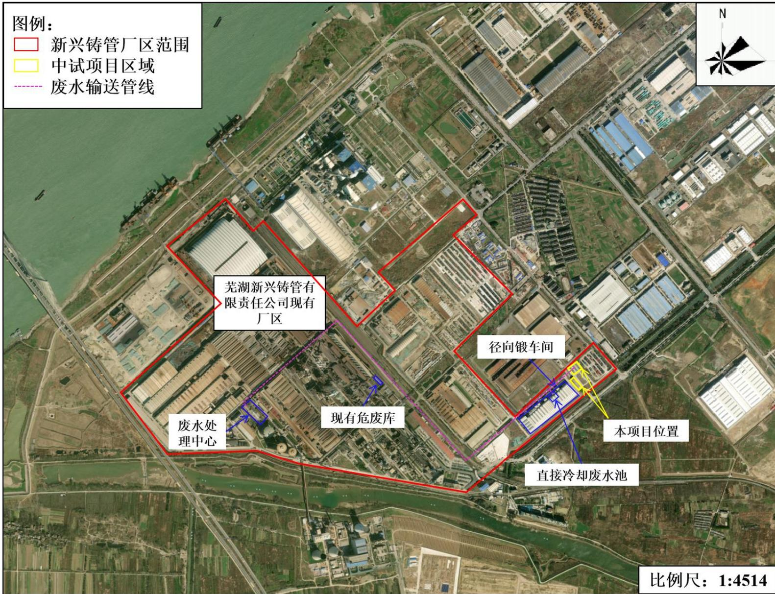
附图 13 厂区废水管线走向图
