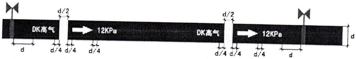
按图所示：第一组文字距离弯头、墙面、阀门、交叉点为管道直径距离，第二组文字结束后距离弯头、墙面、阀门、交叉点为管道直径距离。
