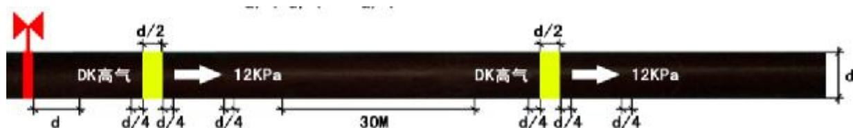
按图所示：第一组文字距离弯头、墙面、阀门、交叉点为管道直径距离，第一组文字结束后距离第二组文字开始前距离为 30 米。
