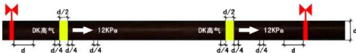
按图所示：第一组文字距离弯头、墙面、阀门、交叉点为管道直径距离，第二组文字结束后距离弯头、墙面、阀门、交叉点为管道直径距离。
